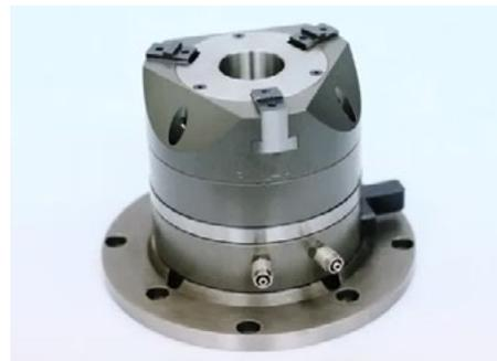
Mandrino ad aria ad alta precisione con tavola rotante progettata in modo univoco per essere montato sul 4° e 5° asse, tavola indexata - verticalmente o orizzontalmente. Questo mandrino ha un pistone ad aria integrato. Riceve l'alimentazione dell'aria dall'unità girevole laterale. La gamma va da 80 mm fino a 200 mm di diametro, il numero di griffe può variare da 2 o 3. unità.
