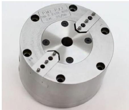
I mandrini pneumatici di precisione fissi con foro passante sono progettati per bloccare pezzi di forma non convenzionale su centri di lavoro CNC verticali o orizzontali, macchine di foratura o maschiatura o per bloccare pezzi più lunghi dell'altezza delle griffe. I mandrini a foro passante possono essere montati su un dispositivo a mandrino singolo o su un dispositivo a mandrino multiplo.
