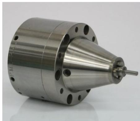
Il mandrino pneumatico di precisione conico è progettato per bloccare utensili da taglio come frese a candela, trapani a colonna, alesatrici, filettatrici e maschiatrici su una rettifica CNC a 5 assi.
