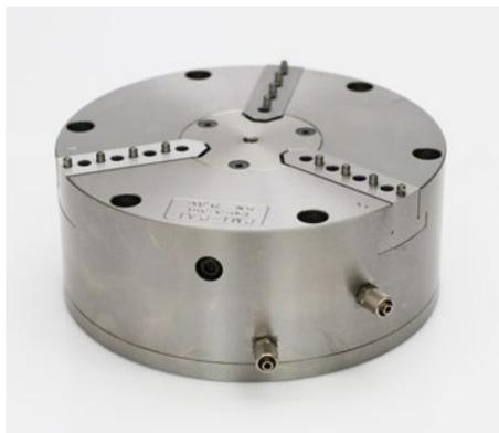
Il mandrino pneumatico di precisione stazionario è progettato per bloccare pezzi tondi e di forma non convenzionale su su centri di lavoro di fresatura CNC verticali o orizzontali, foratrici o maschiatrici. L'aria viene fornita direttamente nel lato del corpo del mandrino e il mandrino può essere montato direttamente sulla tavola della macchina o su una piastra di base. Il mandrino pneumatico per fresatura è disponibile con 2, 3 o 4 griffe.
