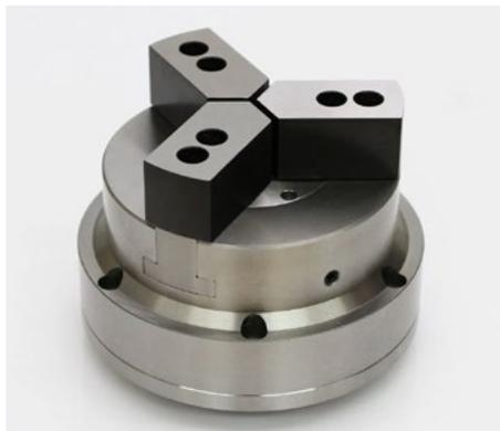
I mandrini pneumatici di precisione ad alta velocità sono progettati per girare fino a 6000 giri/min. Il mandrino ad aria ad alta velocità ha un corpo posteriore ampio con una parte anteriore più piccola, che consente un accesso più facile al pezzo mantenendo una forza di presa molto ampia ad alta velocità di rotazione.
